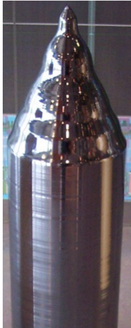
Cristal de Si crecido por el método Czochralski.
