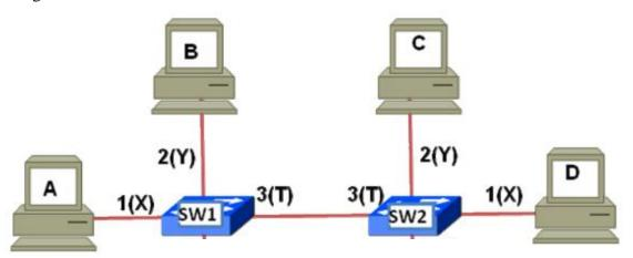
Se han configurado dos VLANs, llamadas X e Y, y se han asignado los puertos de los conmutadores según se indica (la letra T significa que el puerto está en modo 'Trunk').
