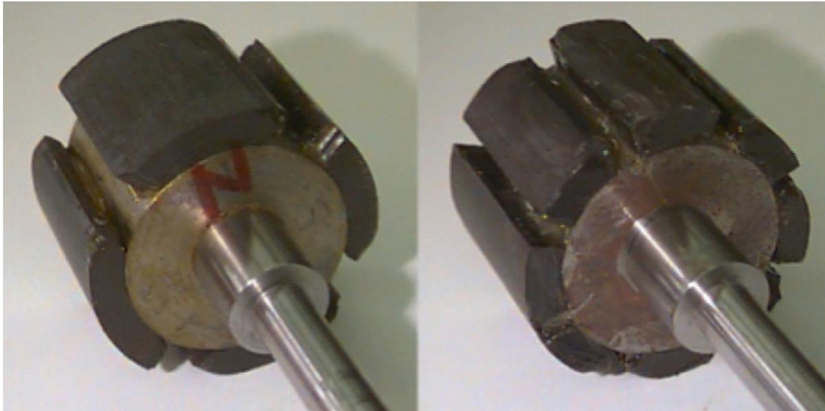
Como el campo magnético en el rotor es básicamente constante, el núcleo del rotor puede ser una pieza sólida, no laminada.
