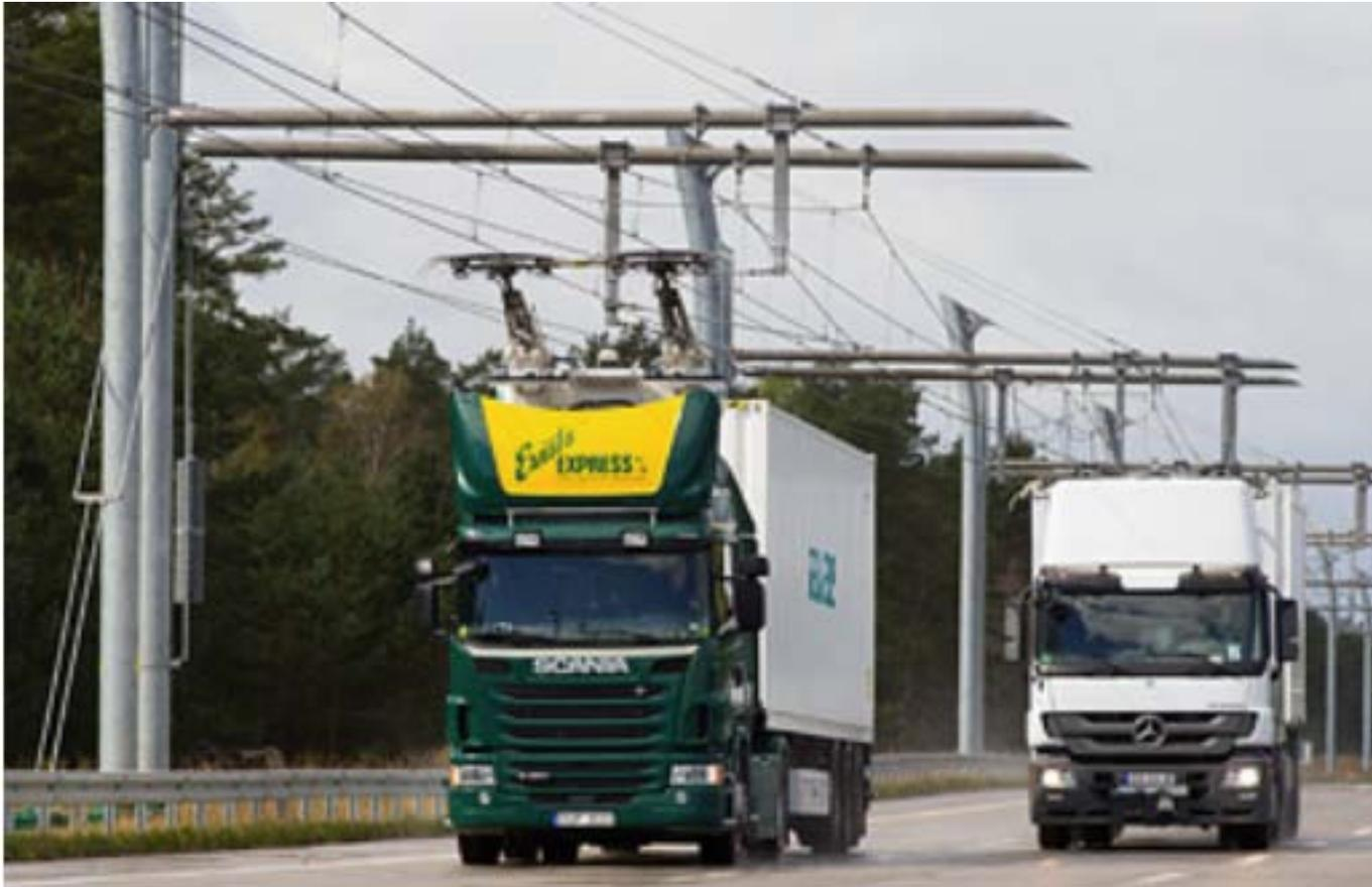
Camiones híbridos diésel-eléctricos de carretera con conexión opcional a la red eléctrica mediante pantógrafos.
