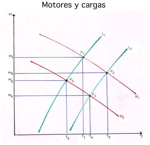
Puntos de operación estables de las cargas  $L_1$  y  $L_2$  con los pares motrices  $M_1$  y  $M_2$ .
