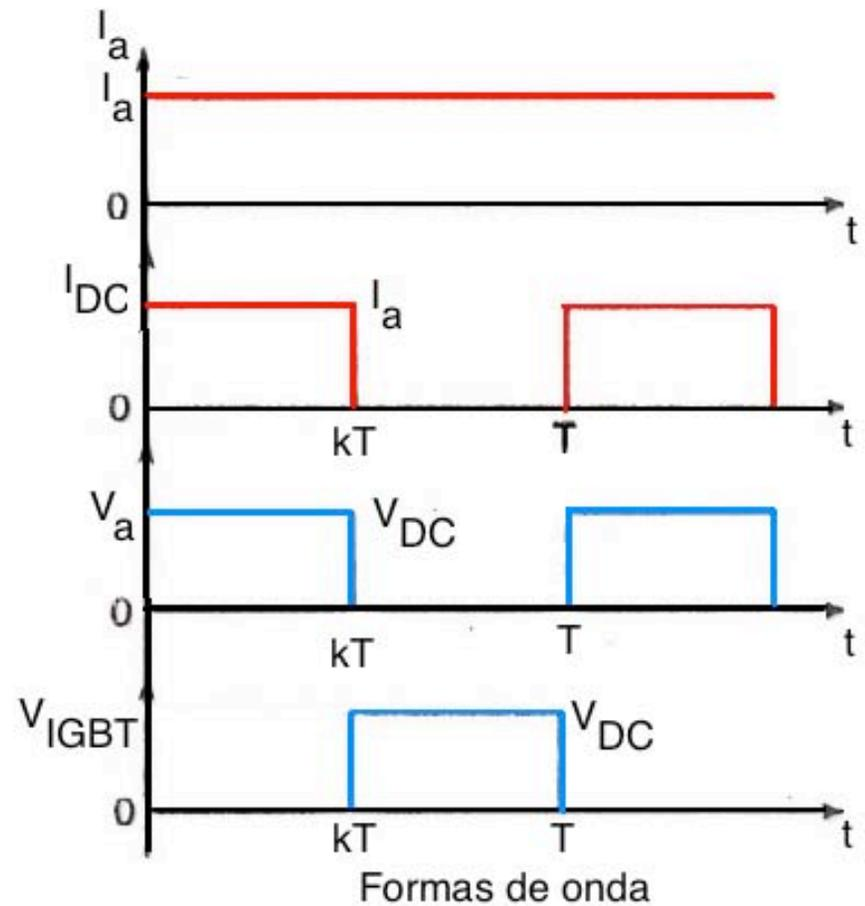
Análisis del actuador reductor de tensión para máquinas DC (regulador "buck").
