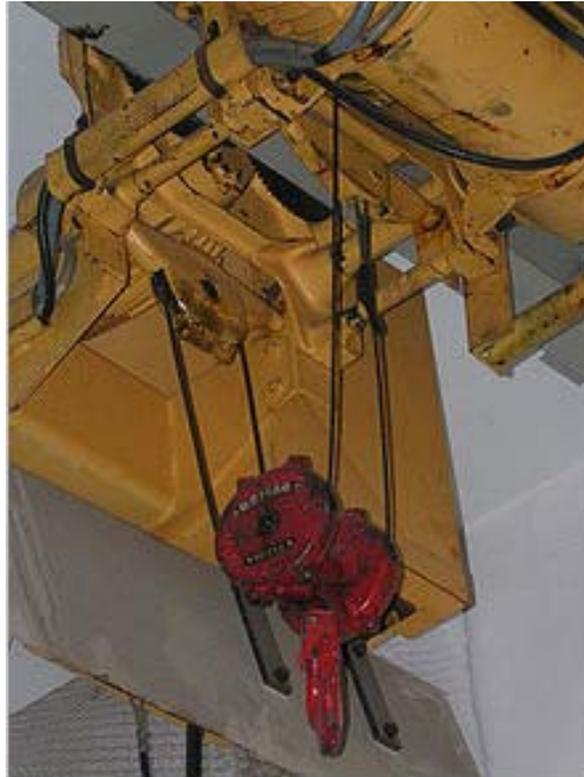
El sistema está formado por un dos conjuntos de poleas, uno colocado en lo alto que permanece en posición fija y otro que sube y baja junto con la carga.
