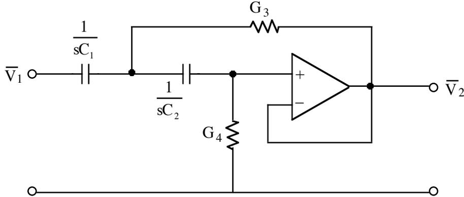
En baja frecuencia, los condensadores bloquean el paso de corriente desde la entrada, mientras que son un cortocircuito en alta frecuencia. Cualitativamente, el circuito se comporta como un filtro pasa-altos. Esto se comprueba con la expresión de  $H(s)$ , la cual tiene la forma de un **filtro pasa-altos**:
