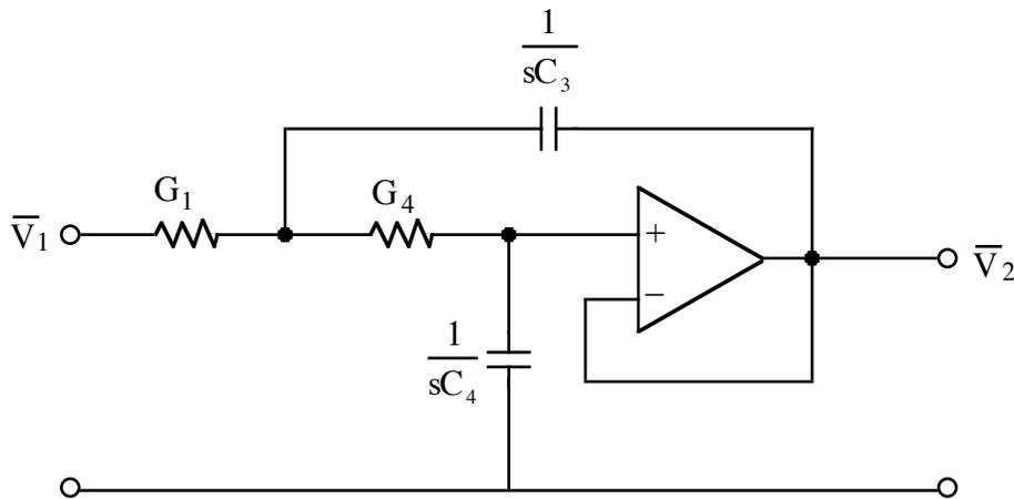
En baja frecuencia, los condensadores son un abierto, por lo que la entrada del seguidor y, por lo tanto  $\bar{V}_2$ , es igual a  $\bar{V}_1$ . En alta frecuencia, los condensadores cortocircuitan al seguidor, por lo cual la salida tiende a cero. Cualitativamente, el circuito se comporta como un filtro pasa-bajos. Esto se comprueba con la expresión de  $H(s)$ , la cual tiene la forma de un **filtro pasa-bajos**:
