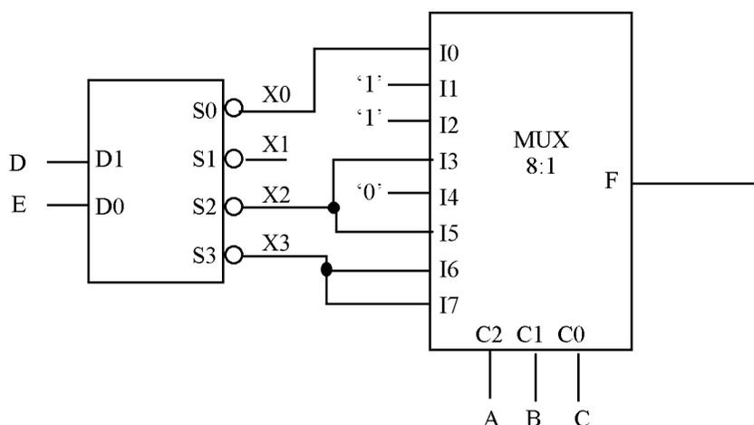
Cada salida  $S_j$  es, internamente, el mintermino " $j$ ", pero el decodificador tiene salidas activas en bajo; haciendo el cambio de variable  $X_j = S_j'$  para simplificar la notación, cada  $X_j$  será el maxtérmino " $j$ ". Sólo necesitamos leer las entradas del multiplexor y combinarlas con las expresiones para los  $X_j$ :
