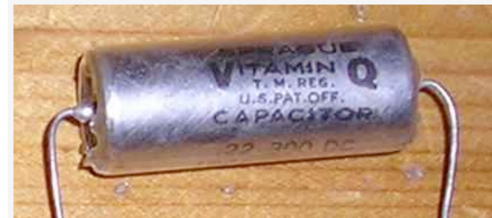
Capacitor con Papel Impregnado como Dielectrico
