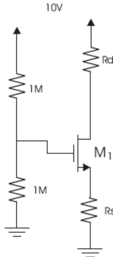
4. Para el circuito mostrado a continuación determinar  $V_o/V_i, Z_i, Z_o$
