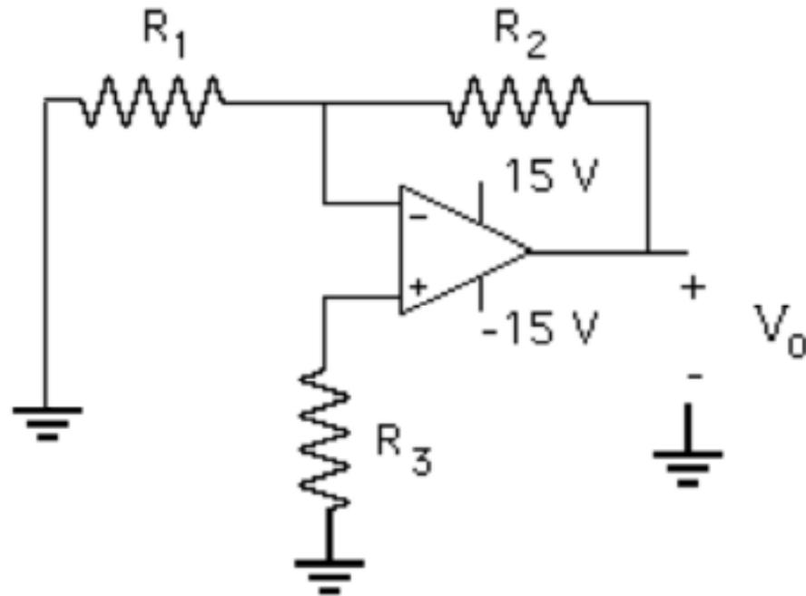
Si el OPAM opera correctamente, el voltaje de salida será de pocos mV (es lo que se llama voltaje de offset).
