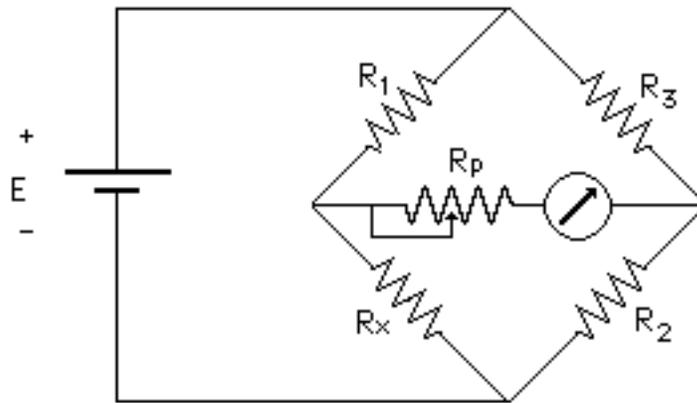
Fig. 5.- Diseño de un puente de Wheatstone.
