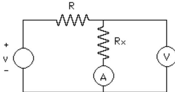
Fig. 1.- Circuito del primer método para medir resistencias.
