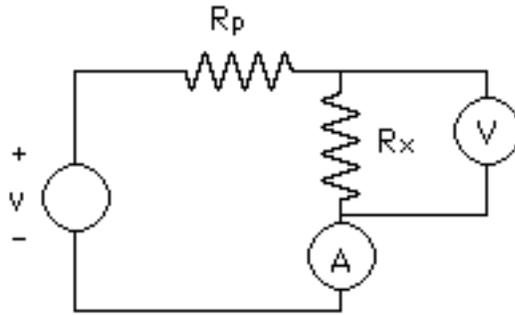
Fig. 2.- Circuito del segundo método para medir resistencias.
