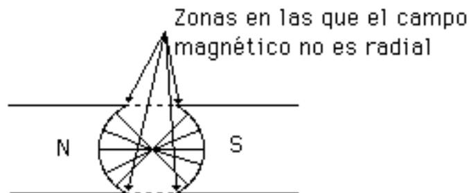
Fig. 13.- Zonas donde se reduce la linealidad del galvanómetro
